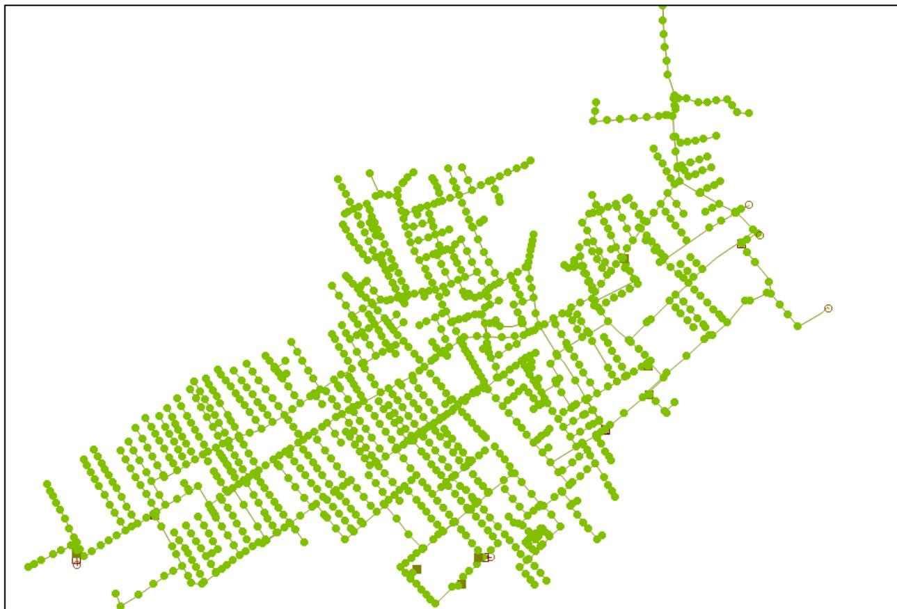
Figura 23. Schema rete fognaria del comune di Canegrate. Fonte Infoworks.
