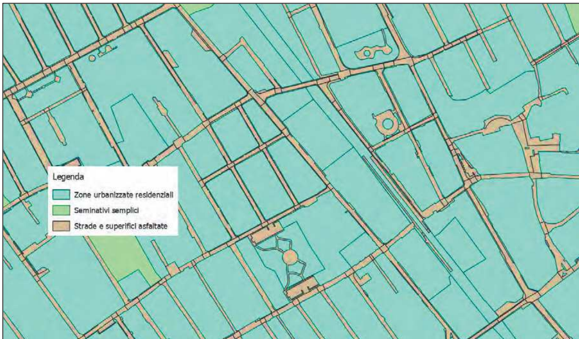
Figura 18. Mappa aree a differente scabrezza implementate nel modello bidimensionale.
