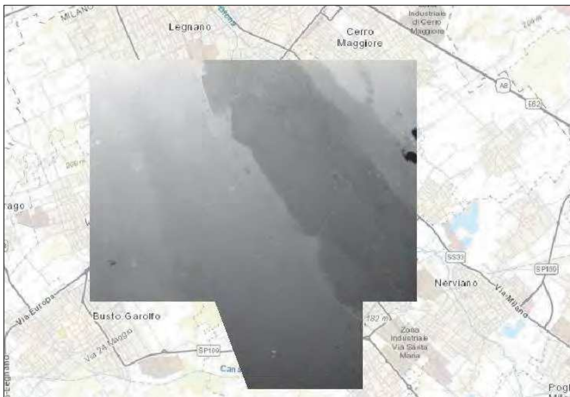
Figura 15. DTM utilizzato nella modellazione bidimensionale. Unione fra LIDAR 1x1 e DTM 5x5.
