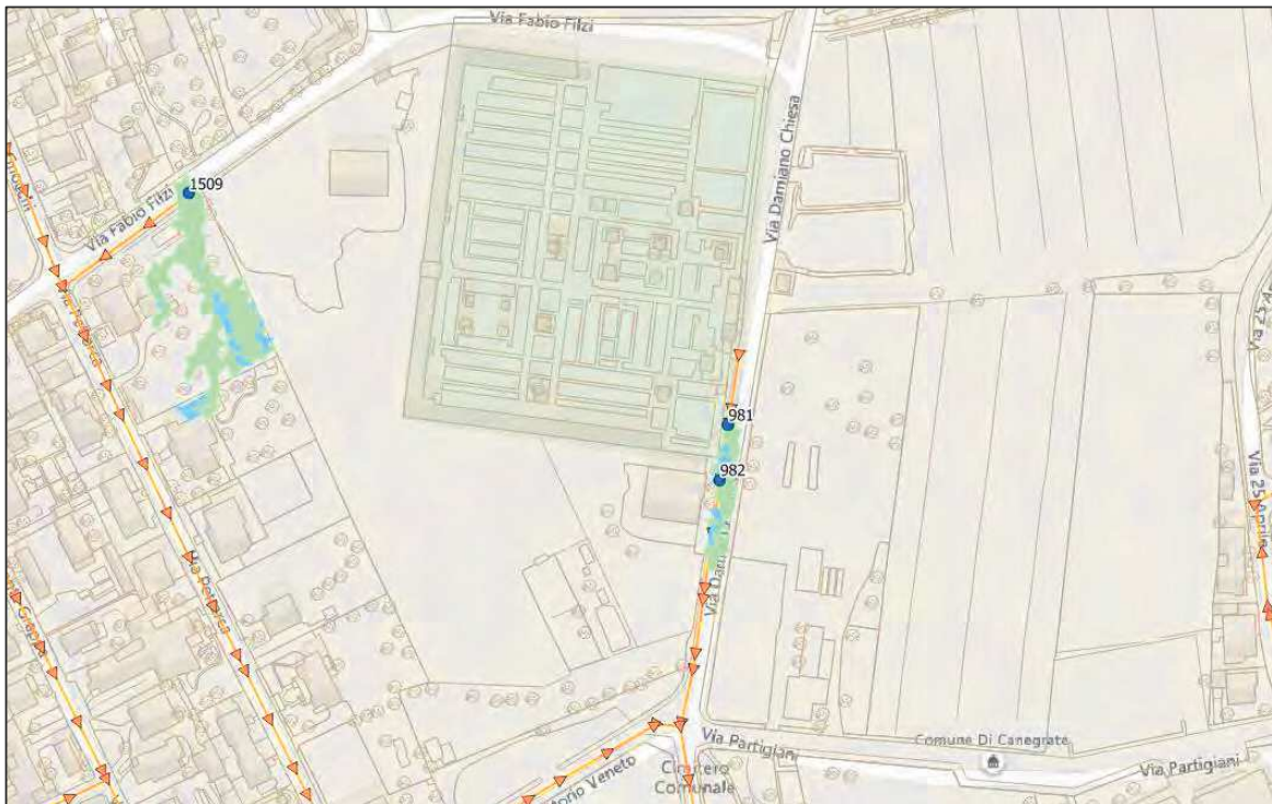
Figura 43. Allagamenti riscontrati su via Filzi alla cameretta 1509 e via Damiano Chiesa alle camerette 981 e 982.
