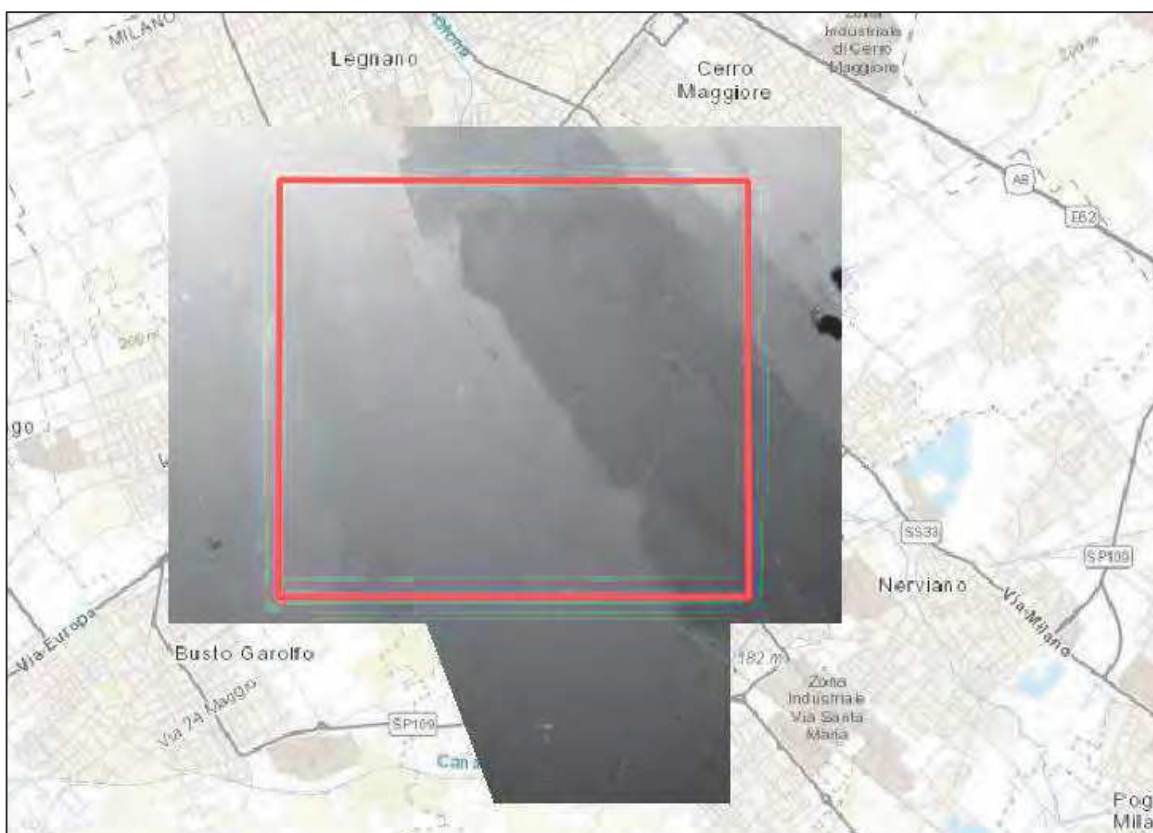
Figura 17. DTM utilizzato nella modellazione bidimensionale. Unione fra LIDAR 1x1 e DTM 5x5. In rosso evidenziato il dominio di calcolo del modello bidimensionale.
